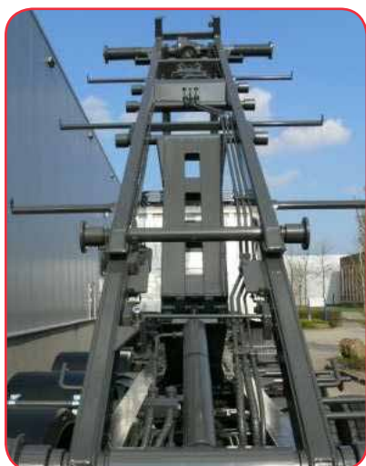
Høj kvalitet tipcylinder. Foldsaks for ekstra stabilitet Robust låse-konstruktion Bagerste side-rulle med flange
